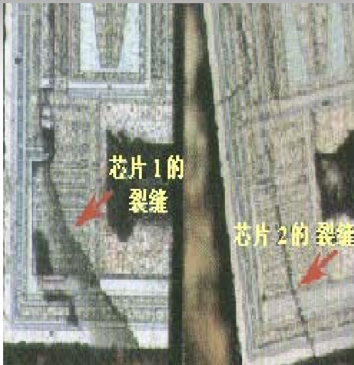
图2.2 (a) 芯片上的裂缝侧面图
