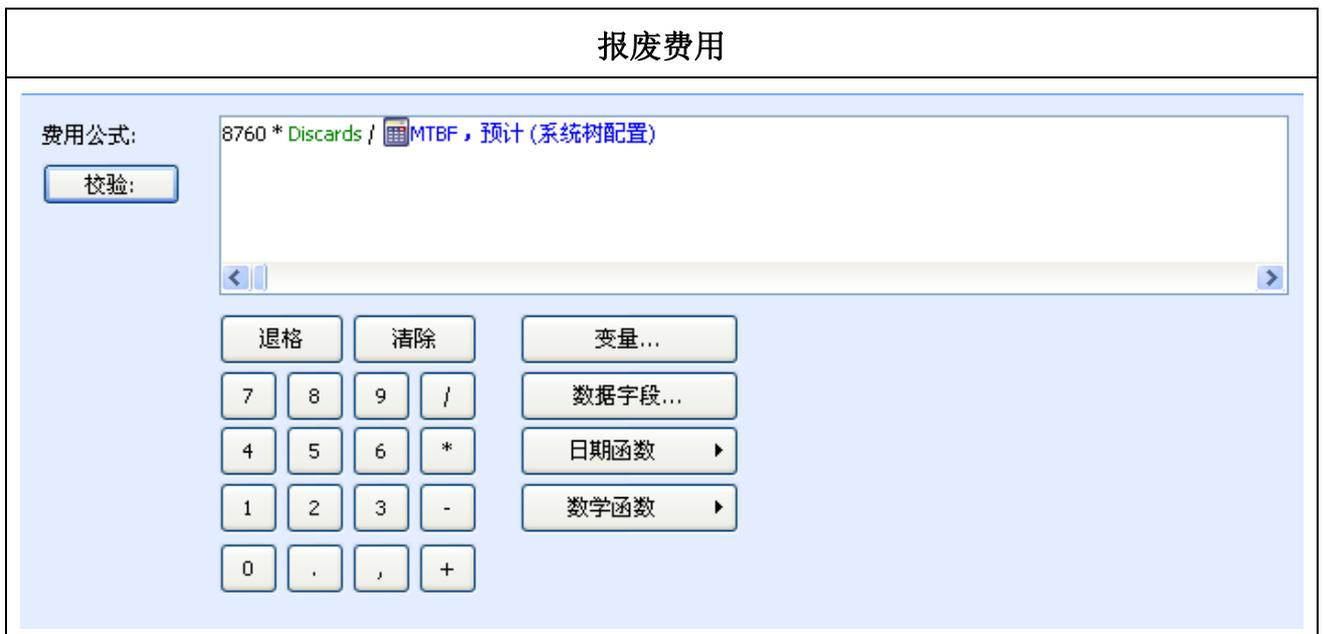
7. 费用计算。在工具栏上点击 **计算** 按钮弹出计算对话框，在计算选项中选中 **寿命周期费用**，在对话框左侧展开 **寿命周期费用**，在 **可选方案** 中选择 **设计方案 1**；**时间周期** 中选择所有时间周期；**灵敏度分析** 中选择占空比（数据字段）为敏感参数，变化范围为 30%~100%；在 **链接到系统树** 中将 **设计方案 1** 与车载发射系统相关联，**链接到框图** 选择 **RBD1 原始** 计算完成后弹出 **查看计算结果** 窗口如图 1-5 所示。
