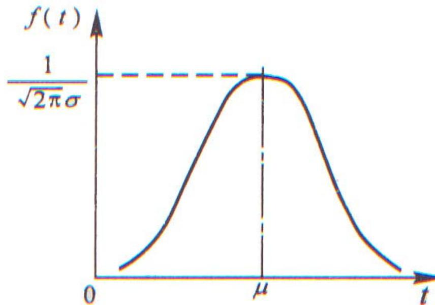
图 1—18 正态分布的失效概率密度函数
