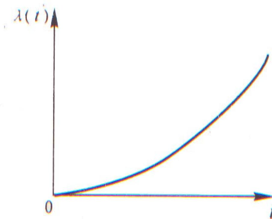
图 1—21 正态分布的失效率函数
