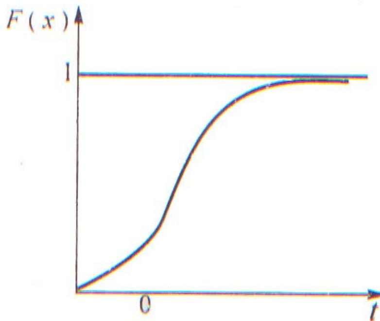
图 1—23 对数正态分布累积失效概率函数
