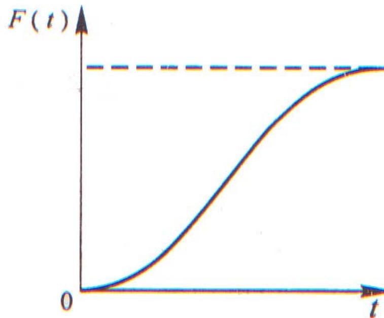
图 1—19 正态分布的累积失效概率函数
