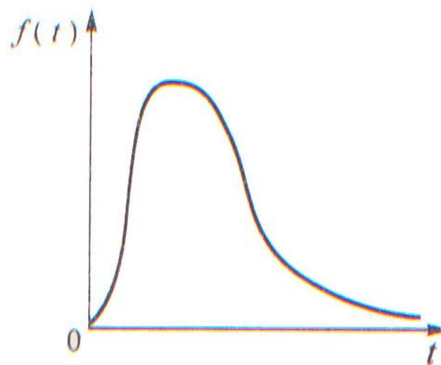
图 1—22 对数正态分布概率密度函数
