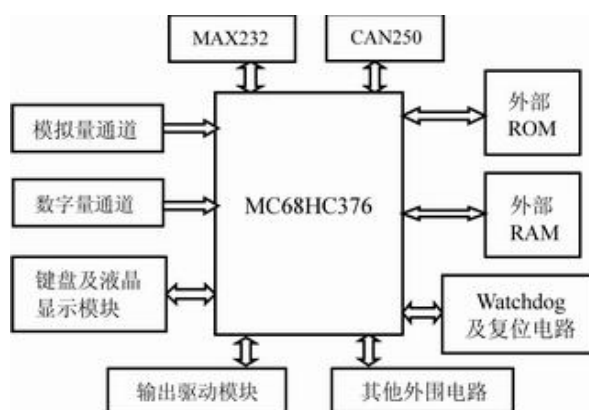
图 1 MC68HC376 应用系统结构框图
